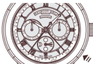
**Remarque:** Suivant la position relative des éléments du mécanisme, le blocage d'un poussoir ou l'absence de mouvement d'aiguille ou du disque de phase de lune est tout à fait possible et normal lors de corrections. En tout cas, ne pas forcer et recommencer les opérations décrites précédemment.
